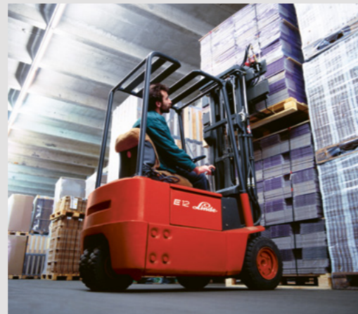
1981: BR 324 mit hydraulischer Servolenkung.
