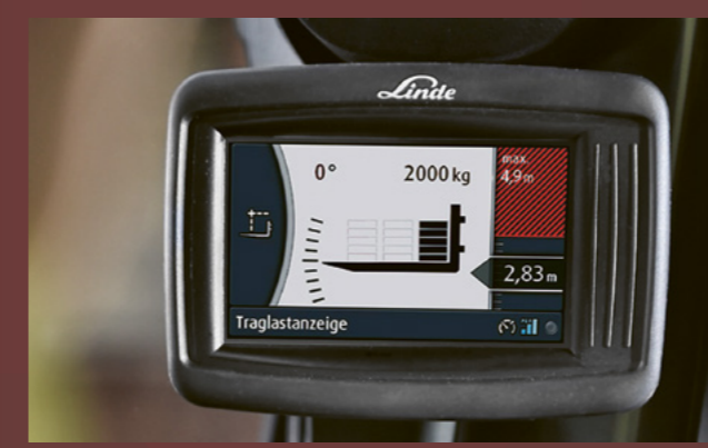
Intelligente Sensoren des Safety Pilot helfen, ein Kippen zu verhindern.
